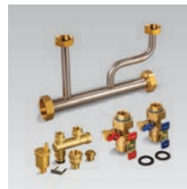
Ensemble pour collecteur principal de chaudière combinée Cet ensemble comprend un collecteur en acier inoxydable, des robinets d'isolement avec joints d'étanchéité, un adaptateur soupape de surpression/évent/protection niveau d'eau, un évent, un adaptateur fileté avec attache et un bouchon pour protection faible niveau d'eau. 30026576A
